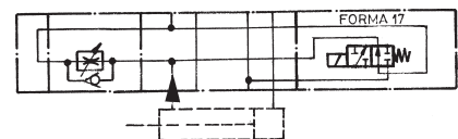
VARIANTE 2: Regulación por "A" en la entrada. Velocidad rápida. VERSION 2: Fast meter out.
